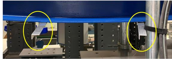
Abb. 3.30 Aluminiumstreben für die Befestigung der Messtaster
