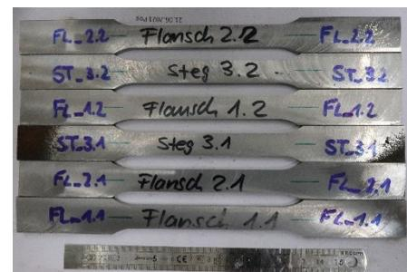
Abb. 3.14 Probestücke des Stahlträgers
