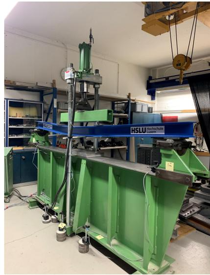
Abb. 7.8 Übersicht auf Vierpunktbelastungsversuch
