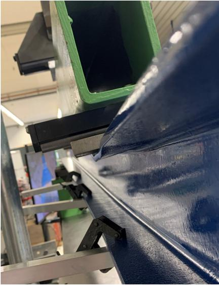
Abb. 7.7 Versagen des Balkens an Position der Krafteinleitung
