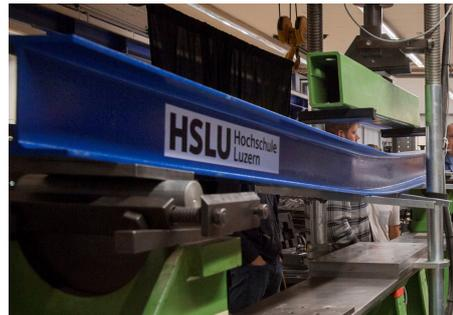
Abb. 7.10 Plastische Verformung des Balkens
