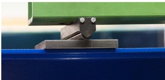
Abb. 3.28 Lasteinleitungspunkt mit Metallplatte ©HSLU
