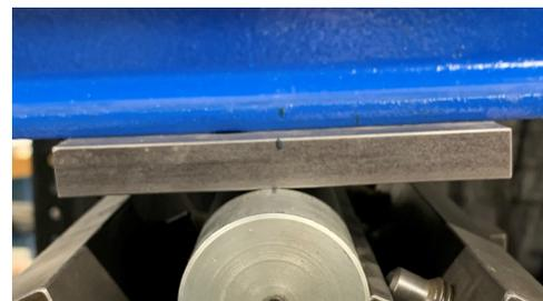
Abb. 3.29 Auflager mit Metallplatte
