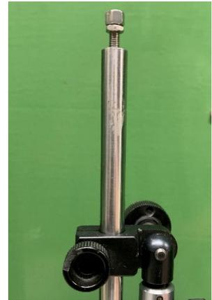
Abb. 3.25 Induktiver Messtaster (Messbereich 40 mm)
