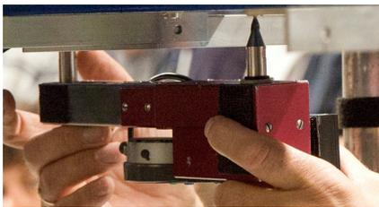
Abb. 3.26 Feinspannungsmessgerät ©HSLU
