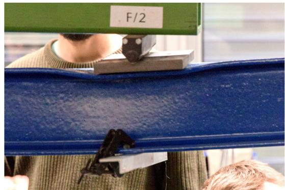
Abb. 3.40 Versagen des Balkens an der Lasteinleitung ©HSLU
