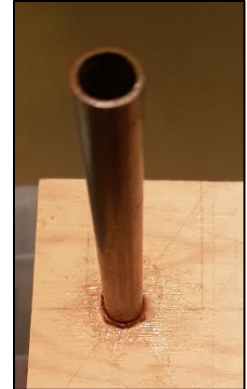
Abbildung 11: Ausrichtungsrohr wirft keinen Schatten
