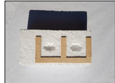
Abbildung 31: Styroporquader mit Holzhalterung und Vertiefungen für die Widerstände
