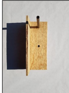
Abbildung 12: Holzhalterung mit Ausrichtungsstab
