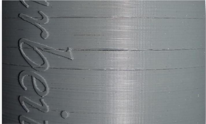
**Abb. 15:** Risse in der Aussenhülle des Stator-Gehäuses.
