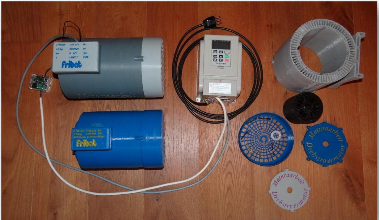
**Abb. 26:** Die wichtigsten Teile, als Ergebnis der Maturaarbeit Drehstrommotor aus dem 3D-Drucker.
