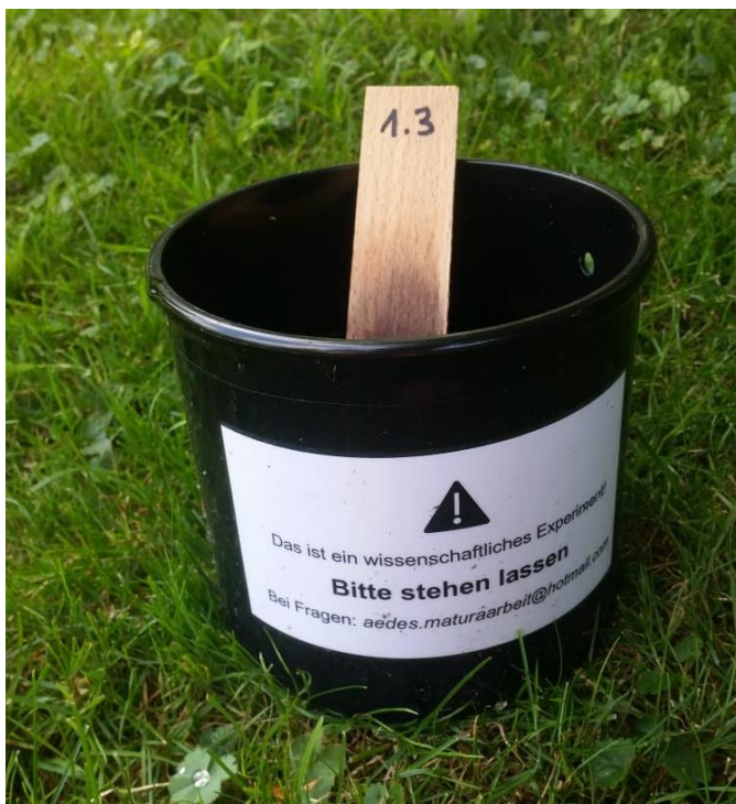
Abb. 13: Ovitrap: Eingesetzter Fallentyp (Plastiktopf und Holzbrettchen)
