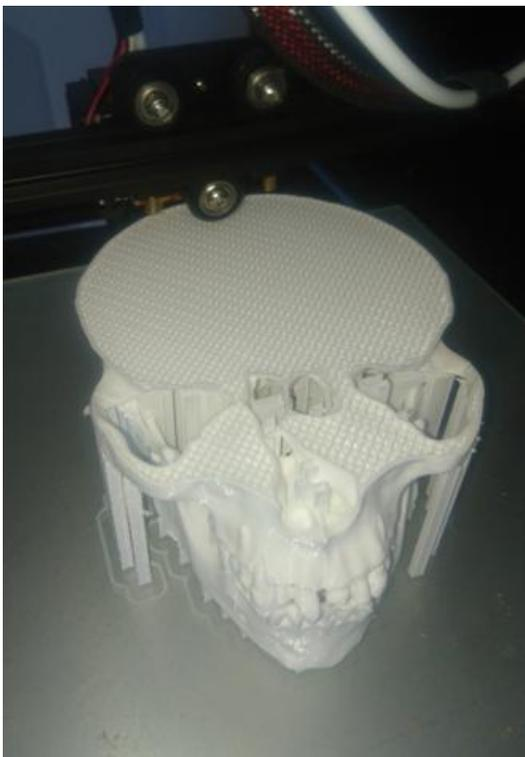
**Abb. 32:** Das Duplikat von Schädel A während dem Druck
