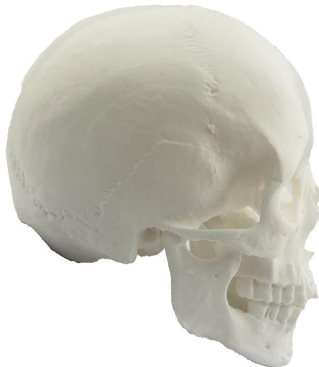
**Abb. 35:** Fertiggestelltes Duplikat aus PLA von Schädel A in der Frankfurter Horizontale von rechts, ungefähr im Verhältnis 1:1.5
