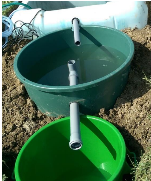
Abbildung 10, Oben (dunkelgrün) Biofilter mit Überlauf zum Pumpensumpf
