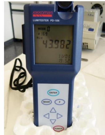
Abb. 9: Luminometer mit einem Messwert (RLU)
