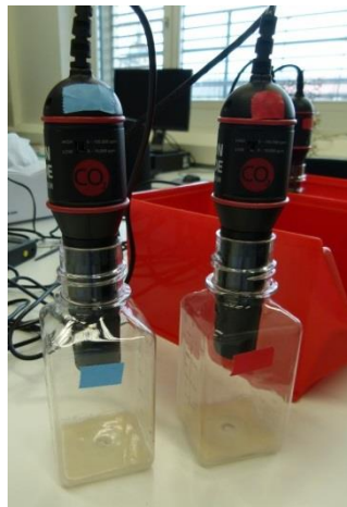
Abb. 5: Zwei Vernier CO 2 -Sensoren mit je 6 ml S. cerevisiae -Suspension
