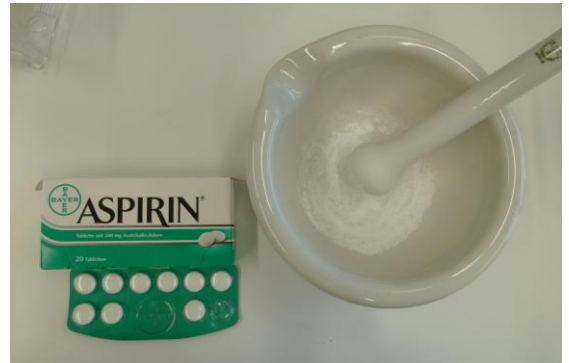
Abb. 6: Eine Tablette Aspirin ® wurde mit dem Mörser zerrieben, um mit NaCl eine Lösung herzustellen und den V. fischeri zu verabreichen.
