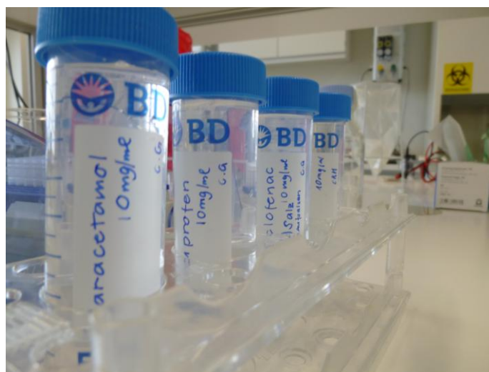
Abb. 5: Wirkstoffe in der 2%-NaCl-Lösung gelöst und aufgesalzen, in Falconröhrchen, Konzentration 10mg/ml
