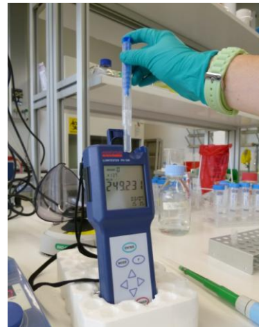
Abb. 10: Küvette wird in den LUMITESTER PD-10N mit Applikator gesteckt
