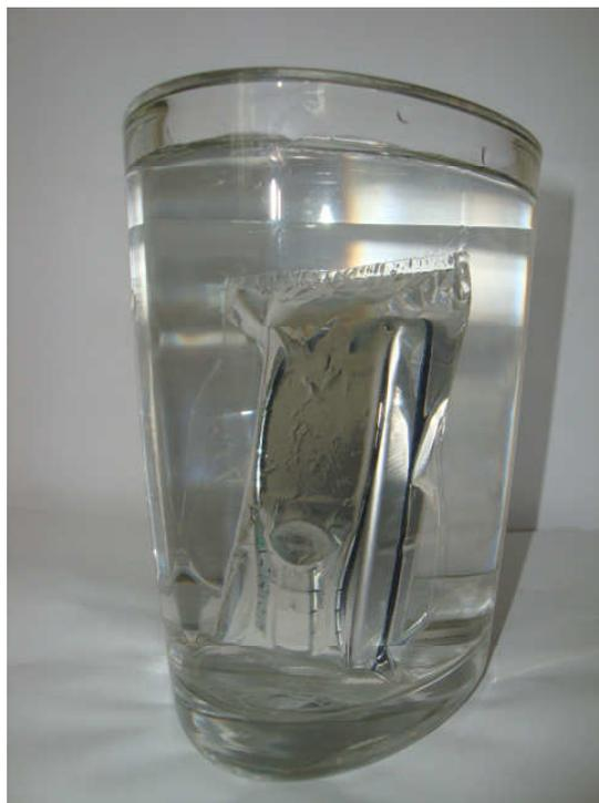
**Abb. 11:** Vakuiertes Handy in einem mit Wasser gefülltem Gefäss
