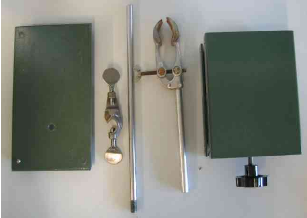
Abb. 11: Der Versuchsaufbau befand sich grösstenteils auf einem Rolltisch mit grosser Tischfläche. Er wurde vor der Abzugskapelle platziert. Darauf kamen ein Stativ mit Stativklammer an einer Doppelmuffe und eine Hebebühne Bochem 12897.
